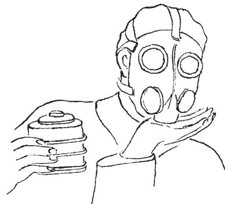
Fig. 4 - Prova di tenuta della valvola di espirazione
