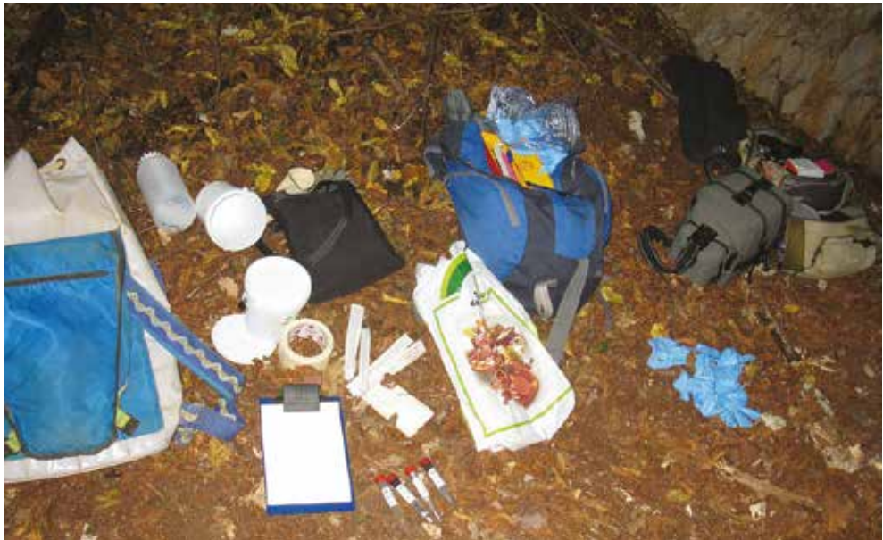
Parte dell'attrezzatura impiegata nel prelievo di campioni di substrato per le analisi chimiche e batteriologiche, nella Caverna presso la 17 VG. (Franco Gherlizza)
