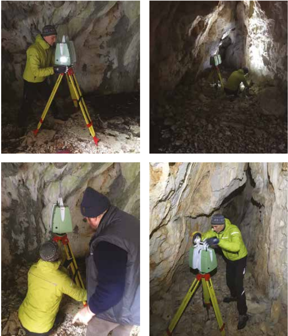
Figura 1 - Campagna di rilevamento delle superfici interne della Caverna Presso la 17 VG e della dolina all'ingresso per mezzo dello strumento laser scan "ScanStation P15". (Josef Vuch)
