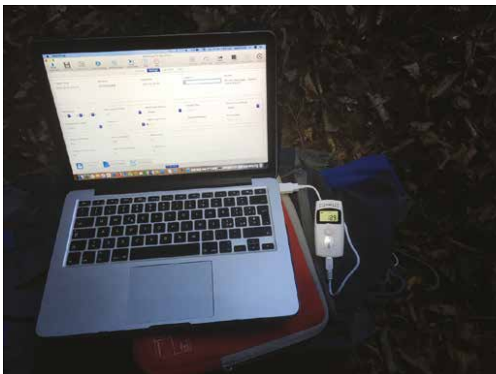
Figura 3 - Registratore RC-4W Elitech Ltd, collegato al computer durante il download dei dati.
